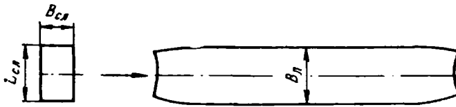
Рис. 297. Схема прокатки толстых листов из слябов (ширина сляба меньше ширины листа, а длина сляба примерно равна ширине листа)
