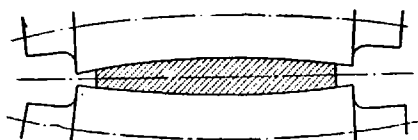
Рис. 299. Изгиб валков при прокатке полосы
